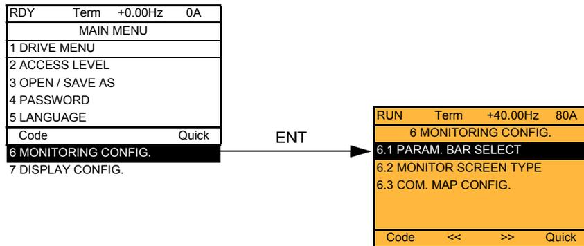
Меню позволяет сконфигурировать на дисплее терминала отображаемую информацию при работе привода.
