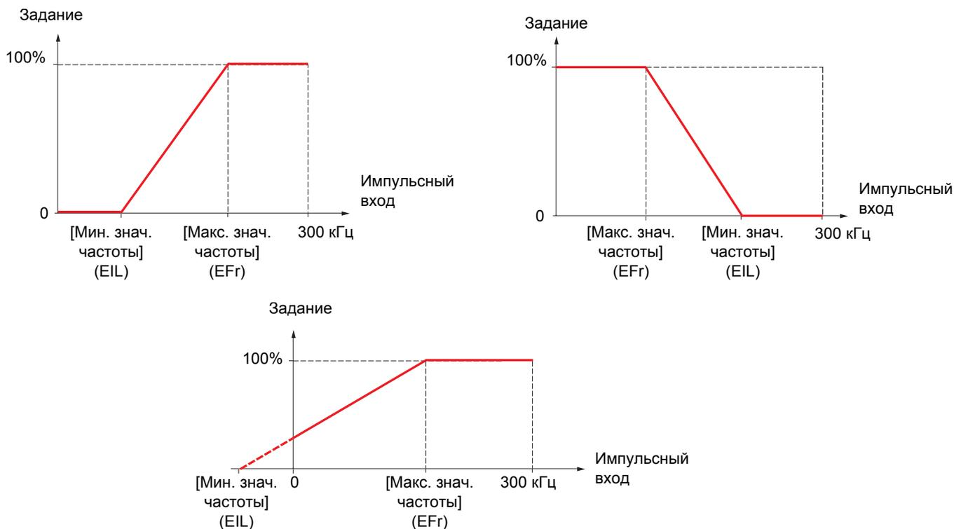
Назначение отрицательного значения для минимальной величины позволяет получить задающий сигнал при нулевой частоте.
