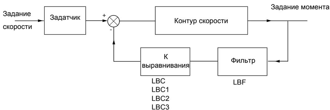
Коэффициент выравнивания нагрузки  $K$  зависит от скорости и момента и определяется двумя коэффициентами  $K1$  и  $K2$  ( $K = K1 \times K2$ ).
