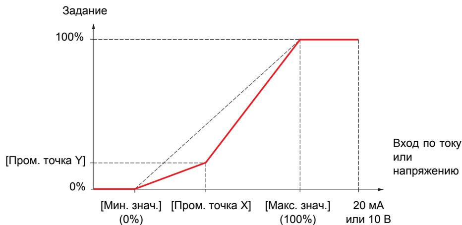
**Примечание:** для параметра [Пром. точка X], 0% соответствует параметру [Мин. значение] и 100% - параметру [Макс. значение]
