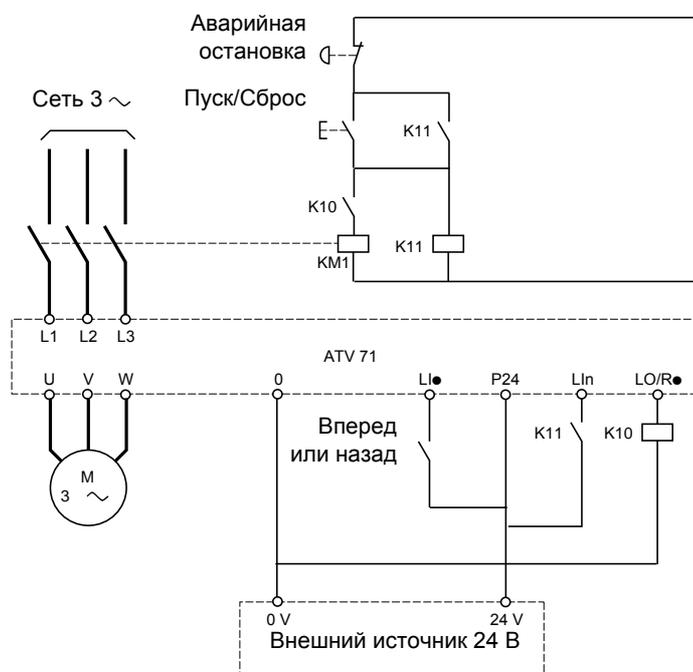
**Примечание:** после нажатия кнопки Аварийная остановка необходимо нажать на клавишу Пуск/Сброс.
