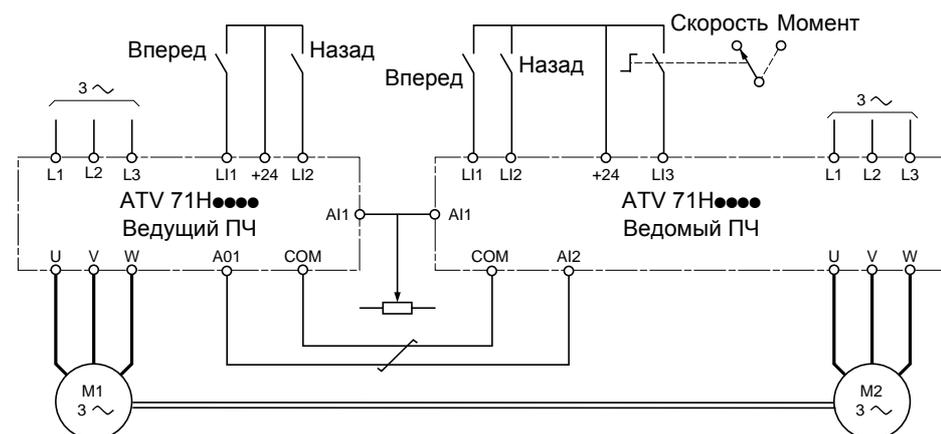
При механической связи двух двигателей замыкание контакта **Скорость/момент** приводит к работе приводов в режиме **Ведущий-ведомый**. Ведущий ПЧ регулирует скорость и управляет ведомым ПЧ по моменту с целью выравнивания нагрузки.
