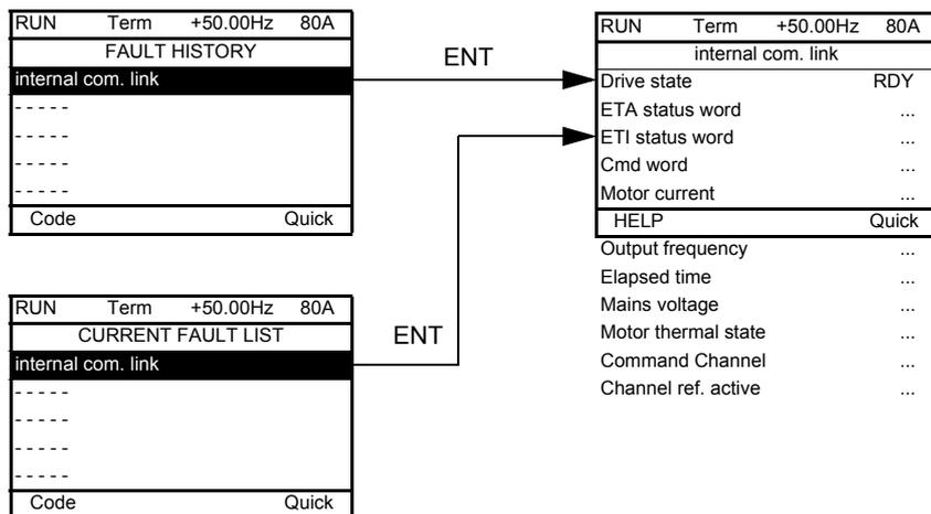
Экран отображает состояние ПЧ в момент появления выбранной неисправности
