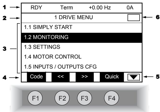
**1.** Строка индикации: ее содержание конфигурируется; при заводской настройке на ней отображаются:
