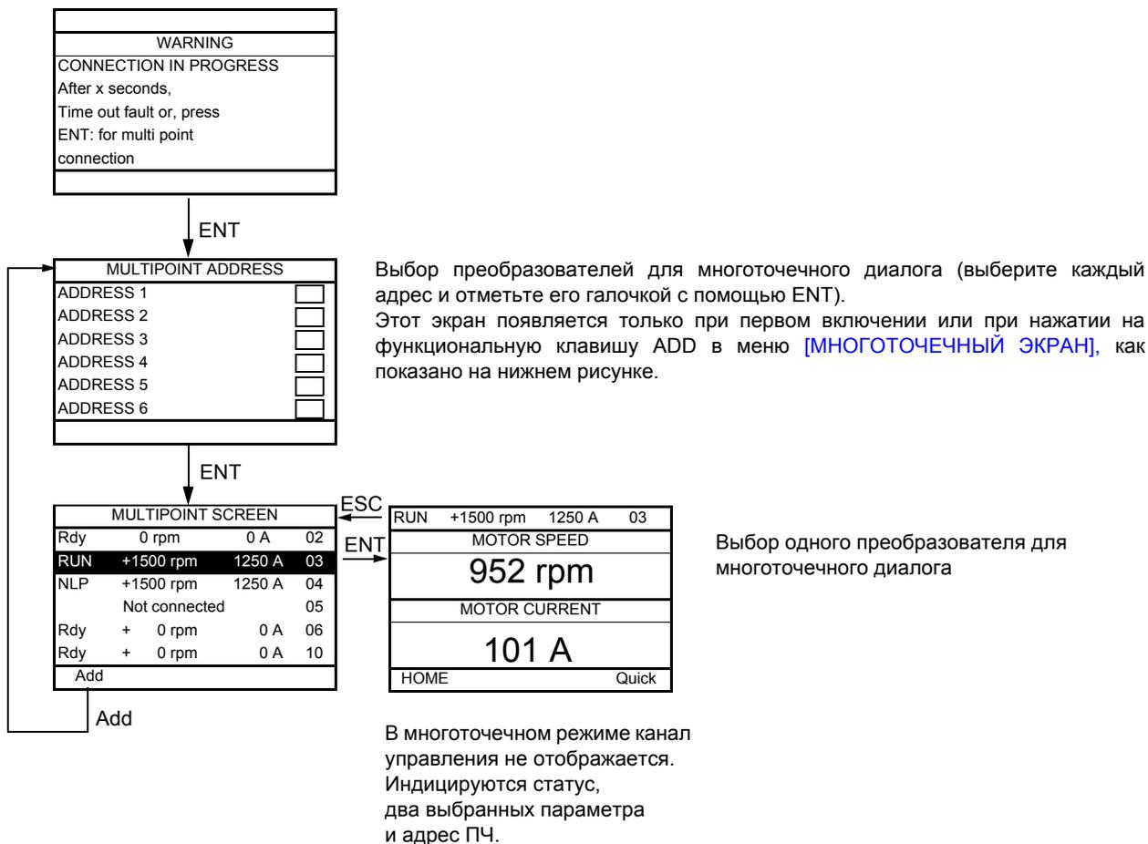
**В многоточечном режиме возможен доступ ко всем меню. Однако управление преобразователями с графического терминала невозможно, за исключением клавиши Stop, которая блокирует все ПЧ. В случае неисправности какого-либо преобразователя отображение переходит на него.**
