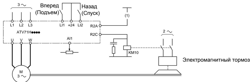
(1) При активизированной защитной функции блокировки ПЧ Power Removal необходимо включить в цепь управления тормоза контакт модуля Preventa для надежного срабатывания тормоза (см. схемы подключения в Руководстве по установке).
