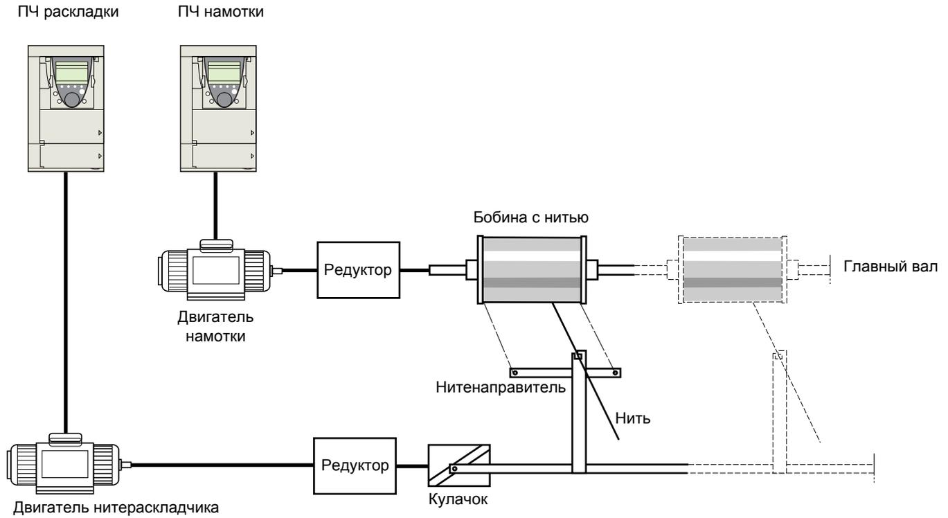
Скорость вращения кулачка должна подчиняться определенному закону для получения качественной намотки с заданной плотностью и шагом:
