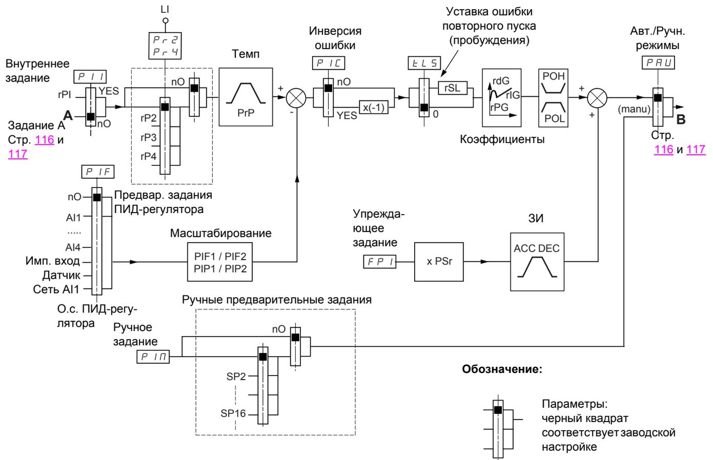
(1) Темп разгона AC2 активен только при пуске функции ПИД-регулятора и во время его "пробуждения".
