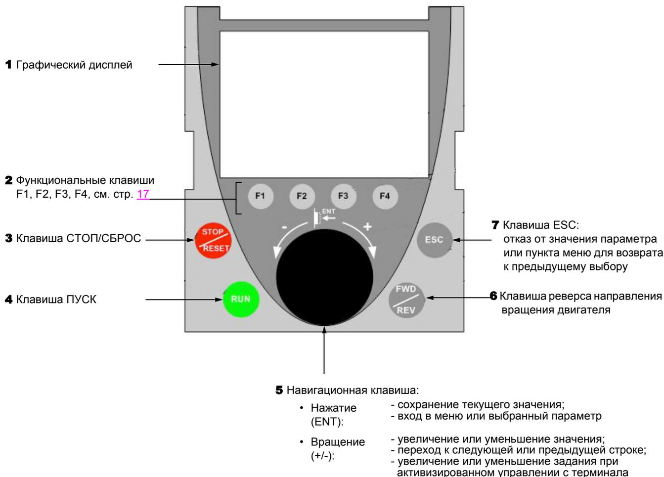
**Примечание:** клавиши 3, 4, 5 и 6 обеспечивают непосредственное управление преобразователем при активизированном управлении с терминала.
