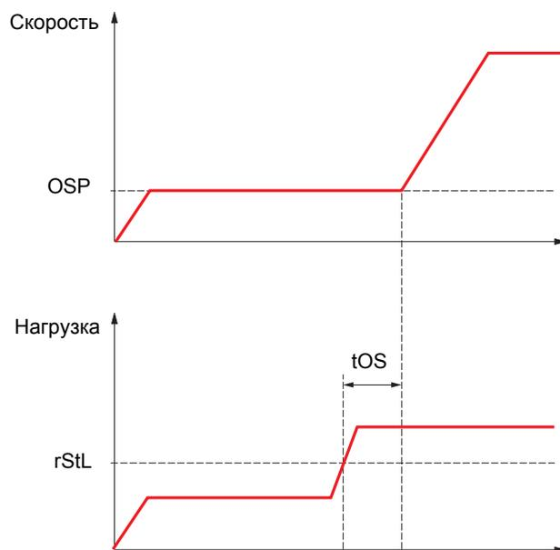
Для измерения нагрузки используется скачок скорости (параметр OSP), описанный на стр [165](#). До тех пор, пока нагрузка не достигнет настраиваемой уставки, соответствующей весу крюка, рабочий цикл измерения (параметры OSP и tOS) не будет запущен.
