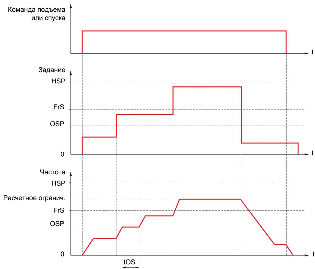
OSP: настраиваемый скачок скорости для измерения нагрузки
