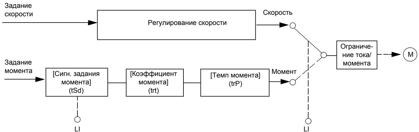
Функция обеспечивает переключение режимов работы при регулировании скорости или управлении моментом. При управлении моментом скорость может регулироваться в пределах настраиваемой зоны нечувствительности. При достижении внутреннего или внешнего ограничения преобразователь автоматически переходит к регулированию скорости (резервной) и остается на этой скорости ограничения. Управление моментом прекращается, и при этом возможны два случая:
