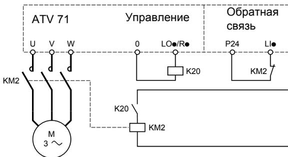
Функции [Назначение выходного контактора] (OCC) и [О.с. выходного контактора] (rCA) могут использоваться индивидуально и вместе.
