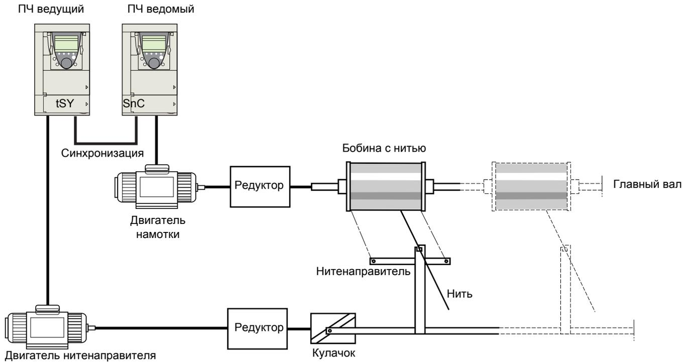
Функция крестовой намотки служит в некоторых применениях для получения постоянного натяжения нити, когда функция раскладки вызывает значительные колебания скорости двигателя нитенаправителя ( $trH$  и  $trL$  см. стр. 205).
