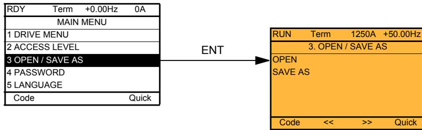
[ОТКРЫТЬ]: загрузка с графического терминала в ПЧ одной из четырех хранящихся в нем конфигураций.
